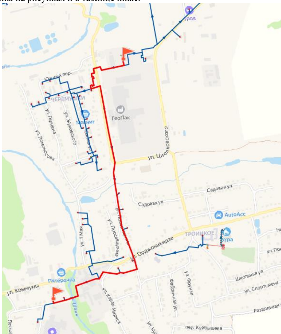
Рисунок 3 - Путь движения теплоносителя от источника тепловой энергии до конечного потребителя, в зоне действия котельной ул. Циолковского
