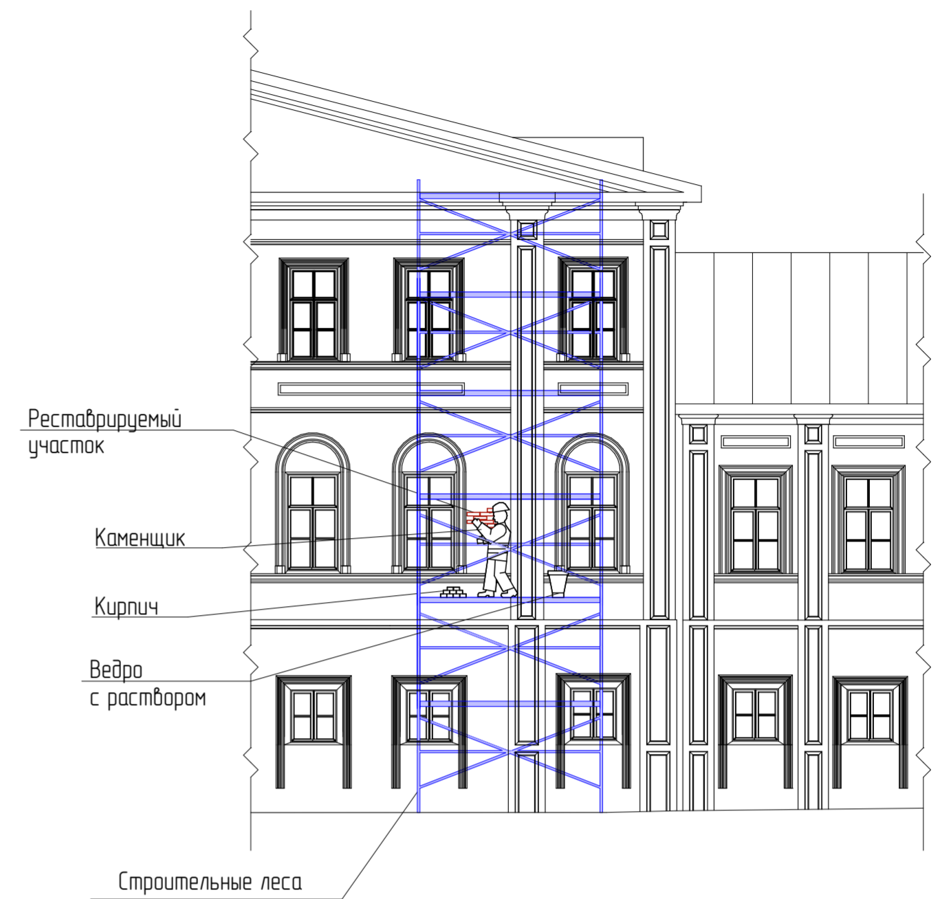
Схема реставрации лицевой поверхности кирпичной кладки. Вид А. М 1:200
