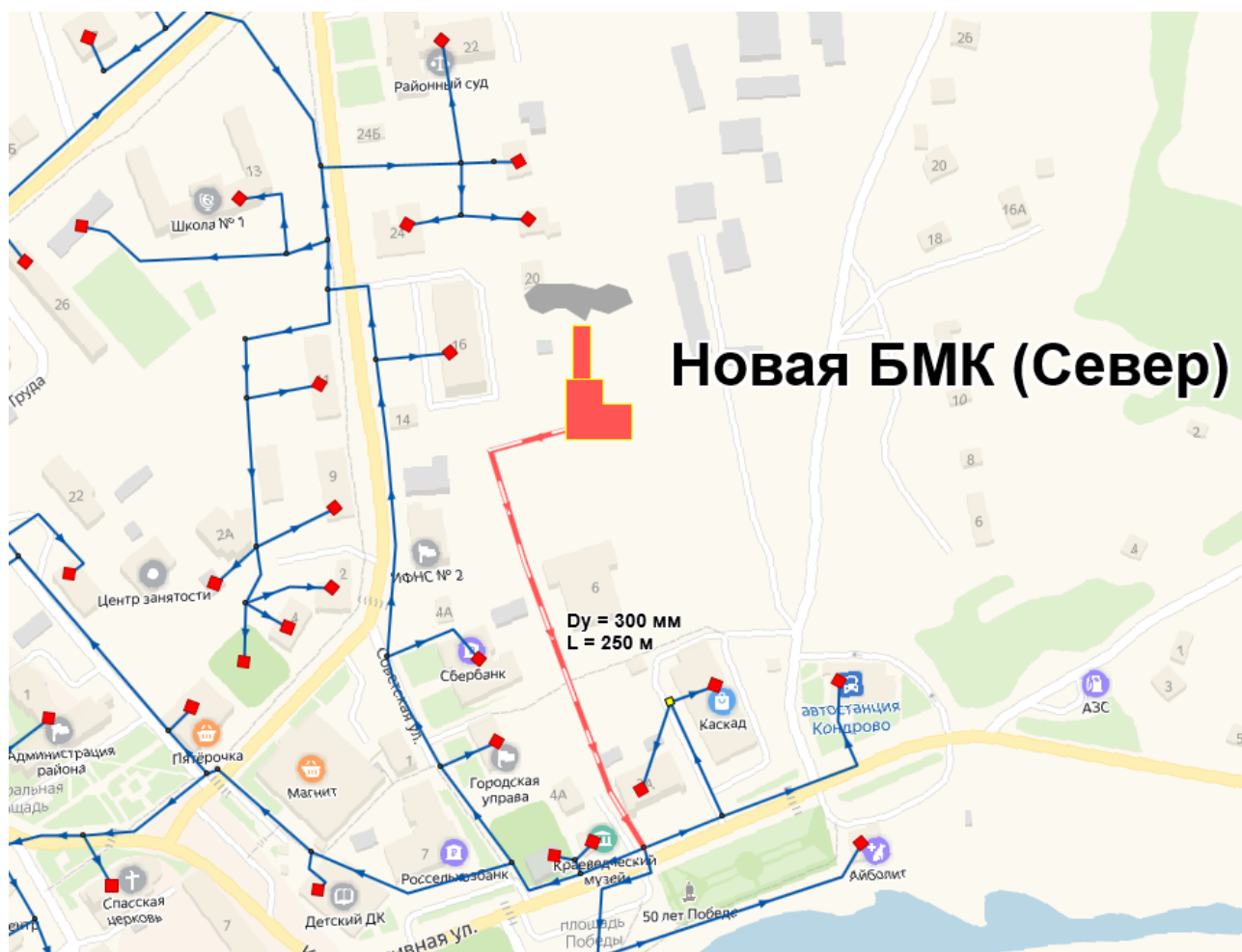
Рисунок 6.4-2 - Строительство участка тепловой сети от БМК-2 (Север)
