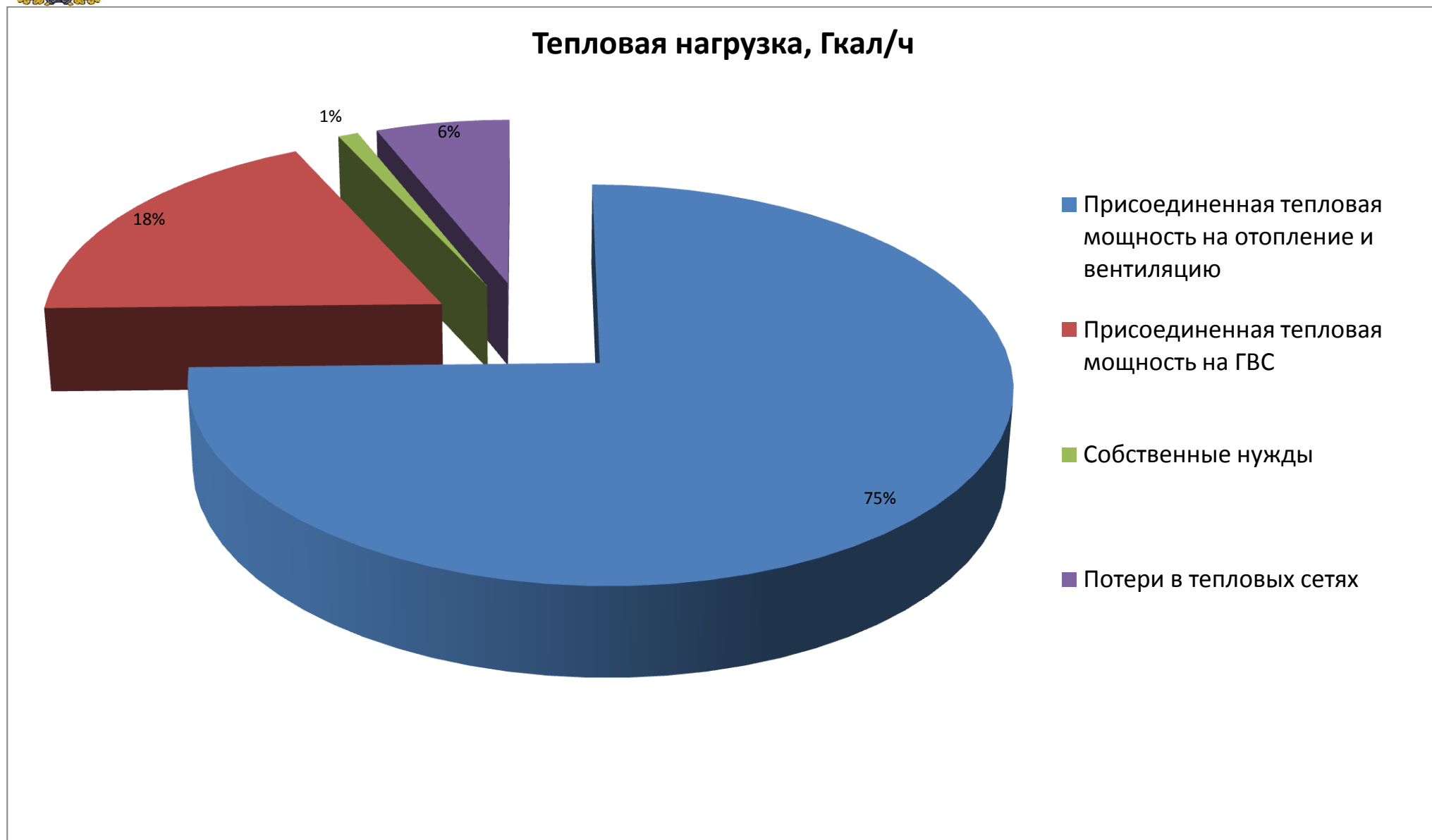
Рис. 1.5. Структура выработки тепловой энергии Котельной Школа
