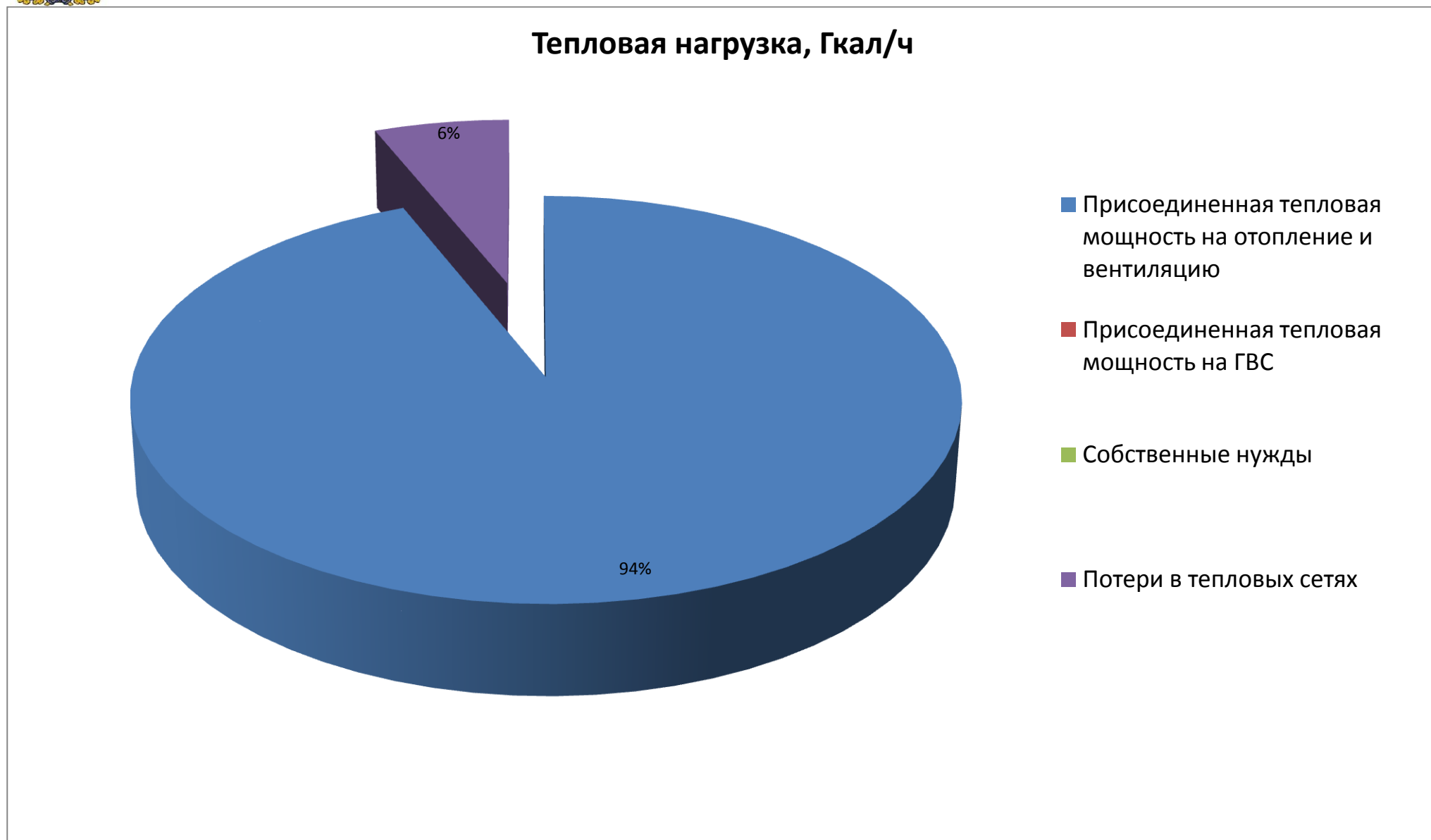
Рис. 1.5. Структура выработки тепловой энергии Котельной ПЗБФ
